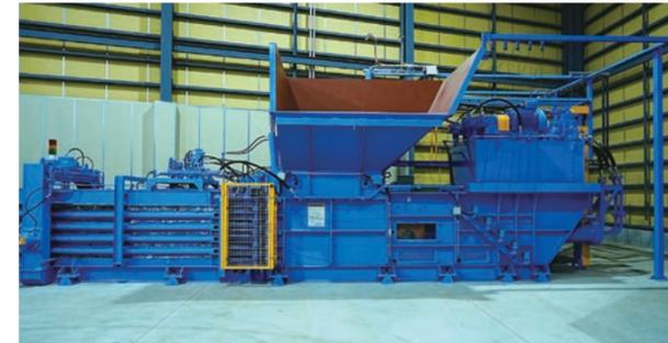
圧縮梱包機。古紙・廃プラ・金属くず・段ボール・ビニル類・硬質プラスチックに対応
